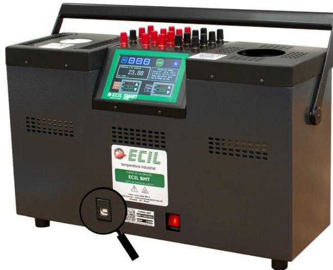
Com o cabo USB 2.0 tipo B fornecido em mãos, conecte uma ponta ao forno e a outra no computador, abra o software e verifique o campo “Status”, o qual deverá aparecer “Conectado”
